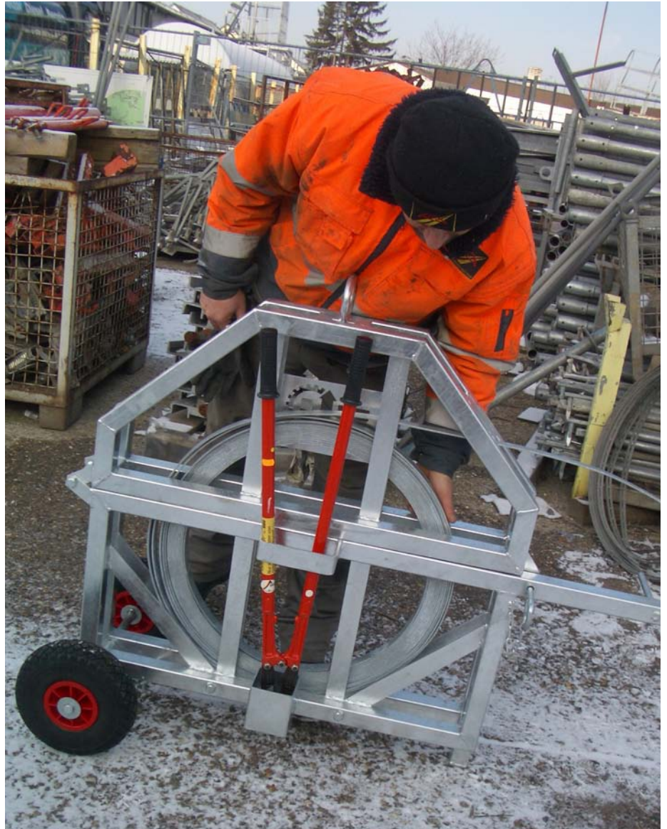
Ein spezieller Erdungsbandabschneider kann direkt am Erdungsbandroller eingesteckt werden.
