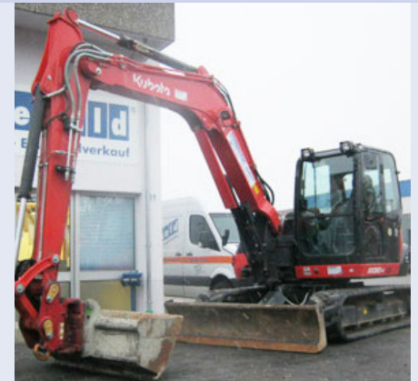
Kubota KX 080-4 Betr.-Std. 820 h, Bj. 2013, Powertilt PTS105 mit HS08, Voll- verrohrung, Überlastwarneinr.
