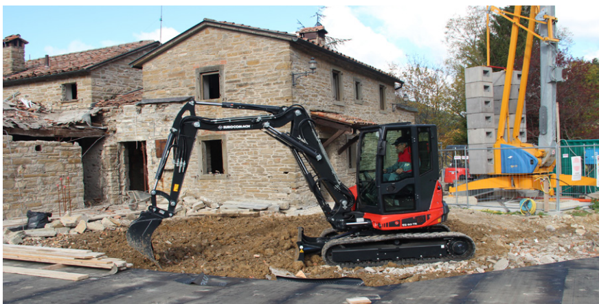
Ein Ausnahmetalent in der 6-t-Klasse: der Eurocomach Kompaktheck-Bagger ES 60 TR mit Verstellausleger.
