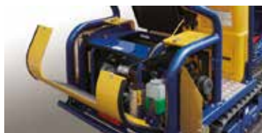
Weit öffnende Abdeckungen für einen einfachen Wartungszugang
