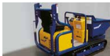
Klappbarer Überrollschutz für Transport und Baustellen mit begrenzter Höhe
