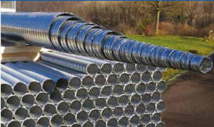
Die MSL-Aussparungsrohre sind schraubenförmig gebogene, verzinkte oder schwarze Wickelfalzhohr mit trapezförmigen Verstärkungssicken (2,0 bis 2,4 mm hoch). Sie sind wasserdicht und bieten hohe Querlast- und Scheitellastfestigkeit, ideal für den Transport und die Lagerung. Die Rohre sind steif, nicht biegsam und besonders für den Einsatz in Unterzügen geeignet.
